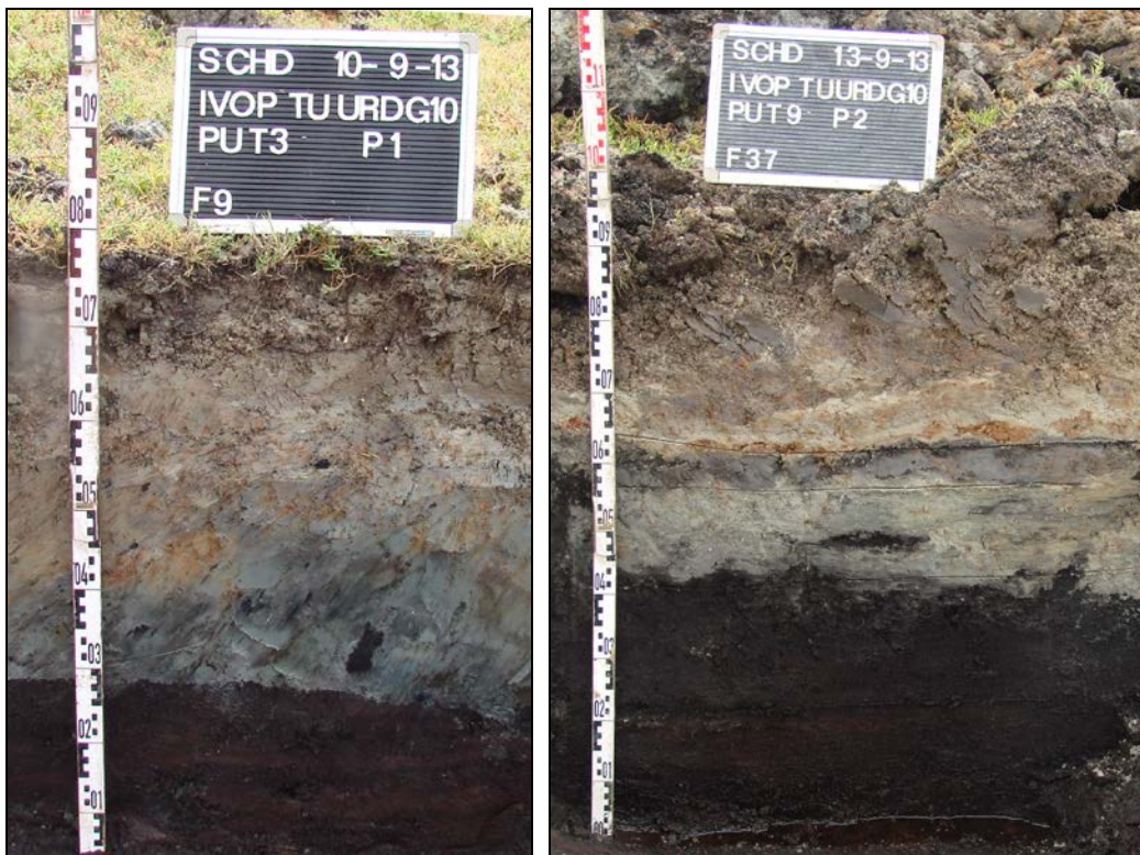
Afbelding 21. Profielkolom nr. 1 van Proefsleuf nr. 3 (links) en Profielkolom nr. 2 van Proefsleuf nr. 9 (rechts), met de (licht) geërodeerde top van het Hollandveen. Respectievelijk Foto nr. 9 (DSCO1359) en Foto nr. 37 (DSCO1531).
